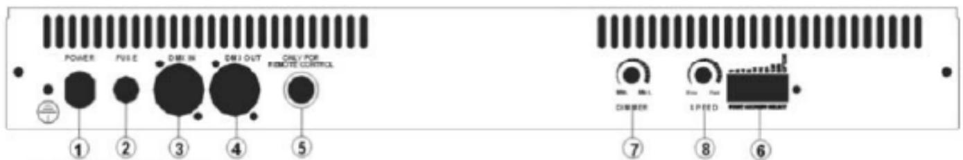
1. **STROMANSCHLUSS:** AC 230V, 50Hz
